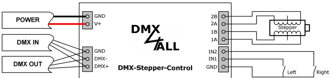
Anschluss mit unipolarem Schrittmotor
