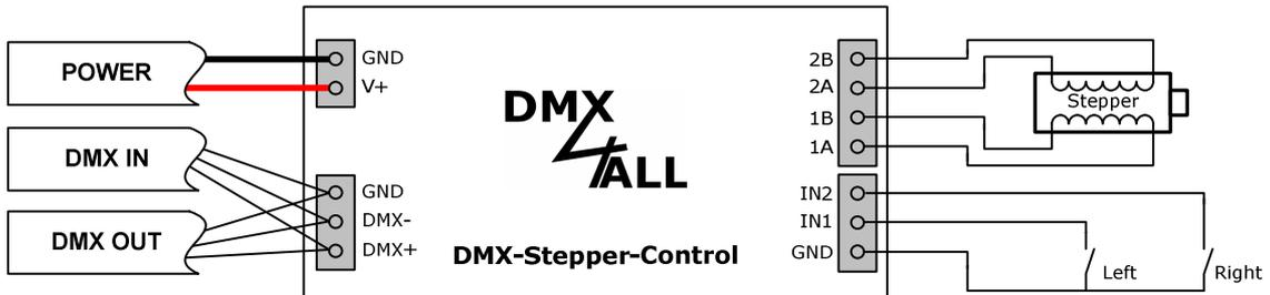
Anschluss mit bipolarem Schrittmotor
