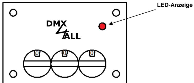
Im Normalbetrieb leuchtet die LED ununterbrochen. In diesem Fall arbeitet das Gerät.
