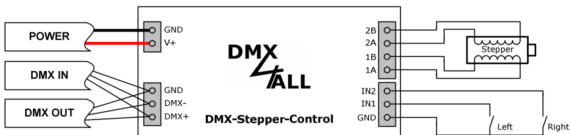
Anschluss mit bipolarem Schrittmotor
