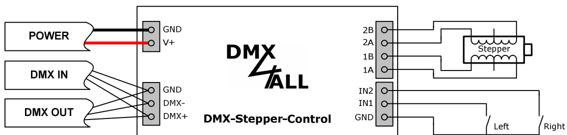
Anschluss mit unipolarem Schrittmotor
