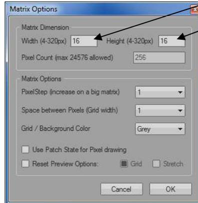
Hier wird nun die Breite (Width) und Höhe (Height) der LED-Fläche eingestellt, in diesem Beispiel 16x16 Pixel.
