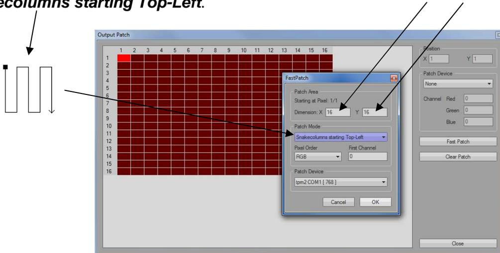
Bei *Pixel Order* erfolgt die Auswahl ***RGB*** und unter *Patch Device* ***tmp2 COM1 [768]***.
